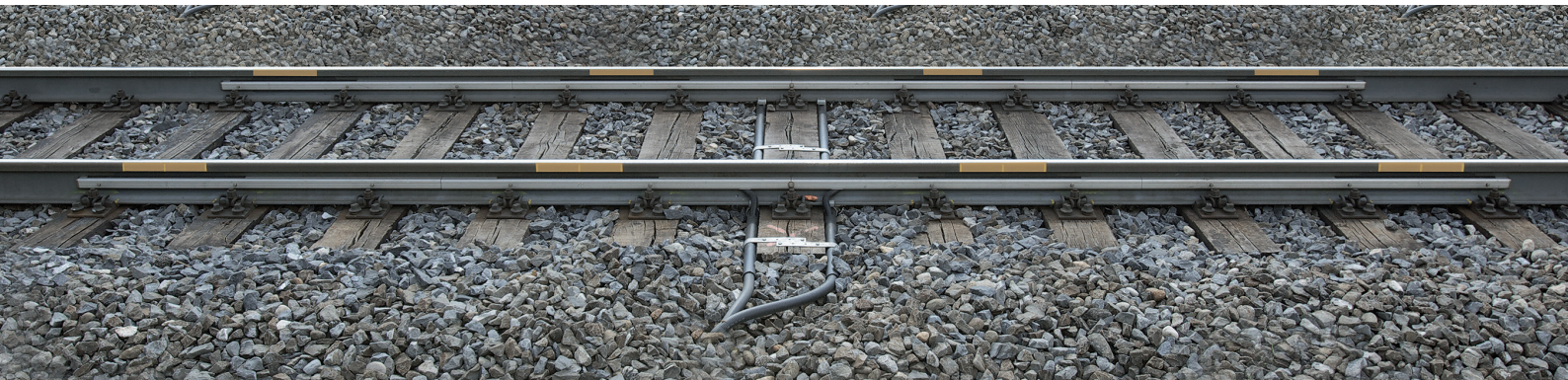
RAWLOC con 8 sensori, traverse di legno
