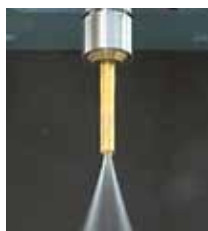
Kühlmittelzuführung durch das Zentrum mit PS-Ring
