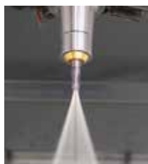
Kühlmittelzuführung durch das Zentrum mit PS-Ring
