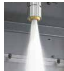
Peripheriekühlung ohne PS-Ring
