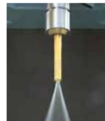
Kühlmittelzufuhr durch das Zentrum
