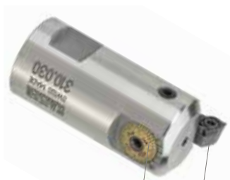
Skalascheibe und Nonius. (1 DIV=0.01 mm \varnothing , mit Nonius 0.002 mm \varnothing )
