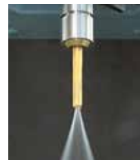
Kühlmittelzuführung durch das Zentrum mit PS-Ring
