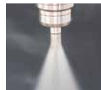
Typ D Kühlmittelzufuhr durch das Zentrum
