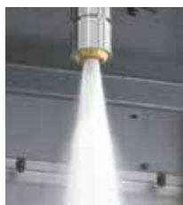
Peripheriekühlung ohne PS-Ring
