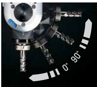
Kinderleicht einstellbarer Spindelwinkel von 0° bis 90°.
