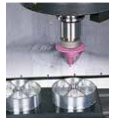
Druckluft reinigt das Werkstück.
