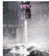
Hoher Kühlmittel- druck entfernt Späne.
