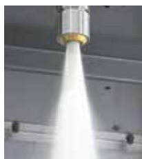
Peripheriekühlung ohne PS-Ring
