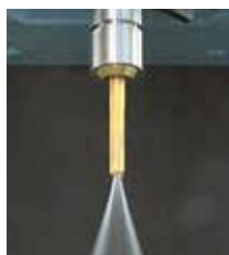
Kühlmittelzuführung durch das Zentrum mit PS-Ring
