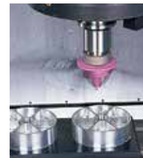
Le souffle sous pression nettoie les pièces.
