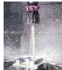
L'arrosage haute pression élimine les copeaux.
