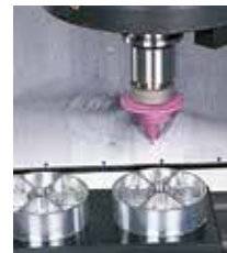
La pressione dell'aria pulisce i pezzi lavorati.
