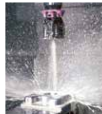
Il refrigerante ad alta pressione rimuove i trucioli.
