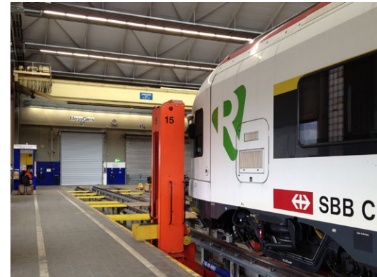
WILOC im aufgeständerten Messgleis
